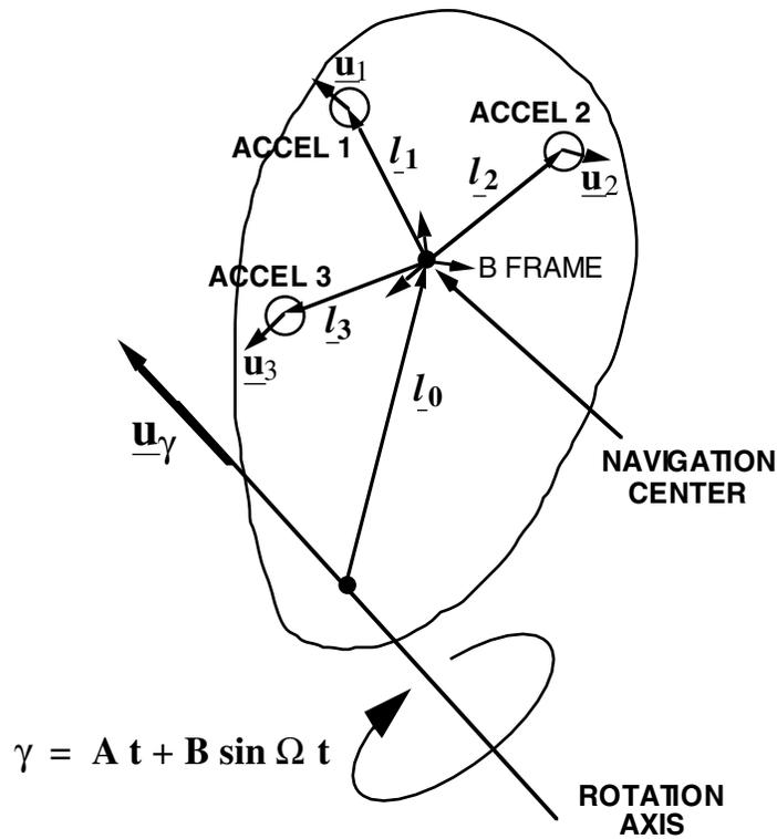
**Figure 2 - SPIN-ROCK-SIZE Parameters**
